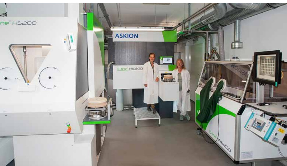
Im Kryolager werden Proben bei Temperaturen bis zu -185^{\circ} eingelagert. Links: Sandra Schonefeld, rechts: Kerstin Nöfer
