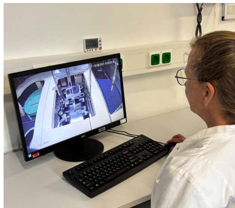
Am Computer kann die automatisierte Herausgabe einer Probe mittels Greifarm verfolgt werden.
