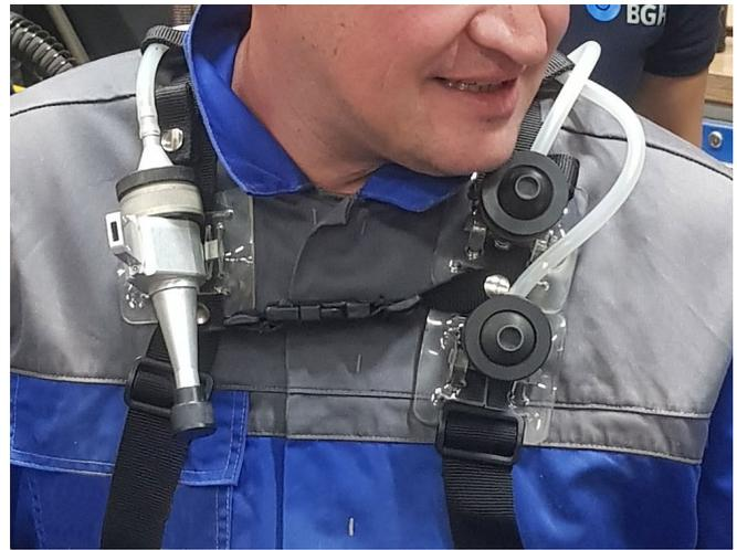
Abb. 1 Personengetragene Messung mit Pumpen
