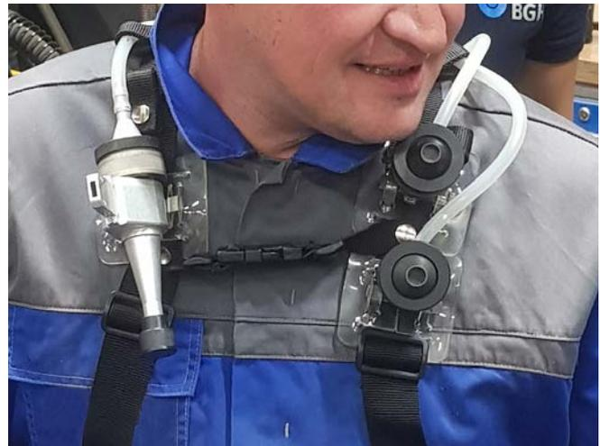
Abb. 1 Personengetragene Messung mit Pumpen
