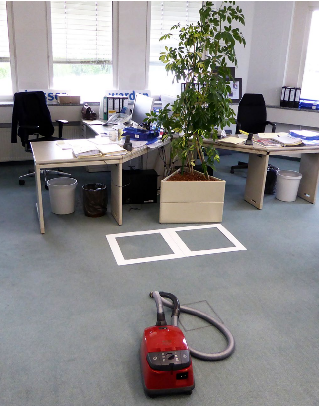
Büro mit Schablonen zur Absaugung der Fläche für die Probenahme auf dem Fußboden.
