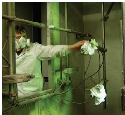
UV-Messung an einer Lackierstraße
