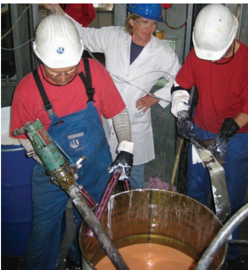
In-Situ-Durchbruchmessungen an Chemikalienschutzhandschuhen
