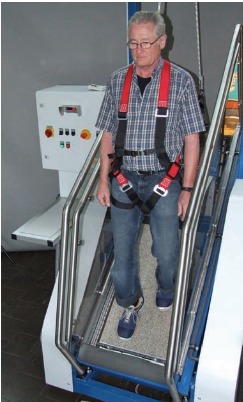
Prüfung der Rutschfestigkeit von Bodenbelägen
