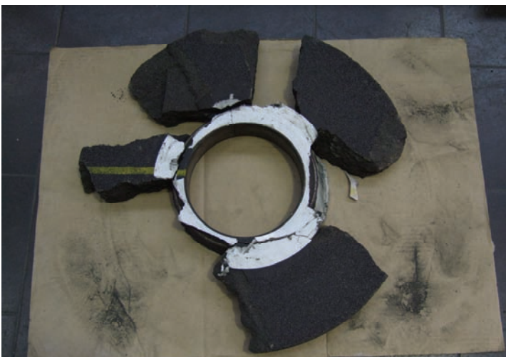
Im betrieblichen Einsatz zerstörte Schleifscheibe
