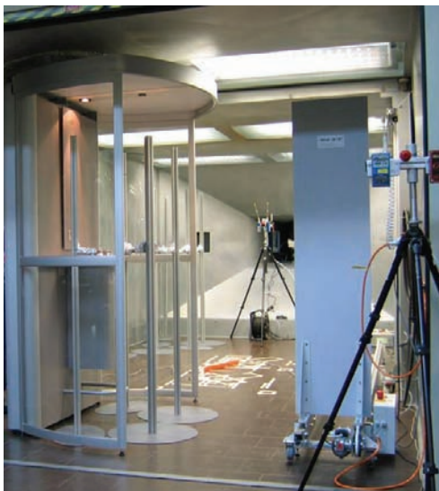
Nichtraucherschutzsystem im BGIA-Prüfstand
