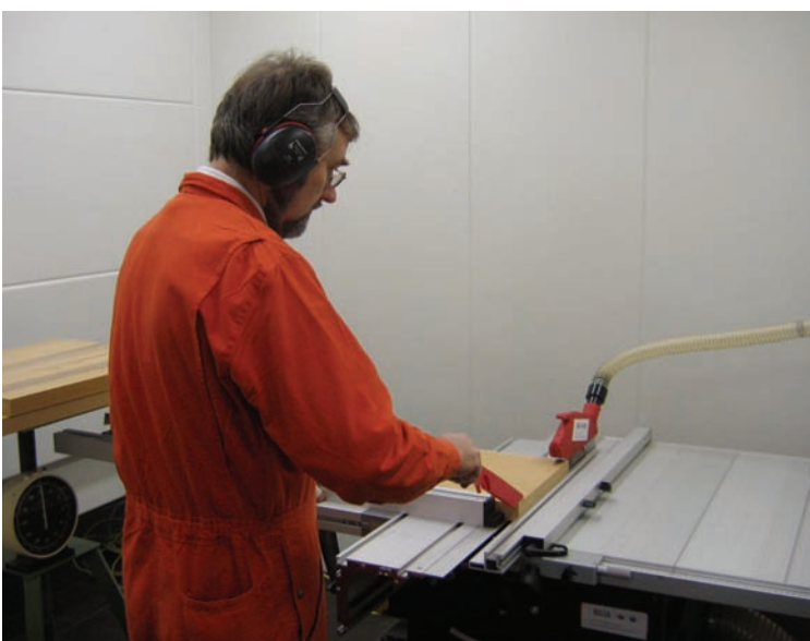
Bestimmung der Staubkonzentration beim Zuschneiden von MDF-Platten
