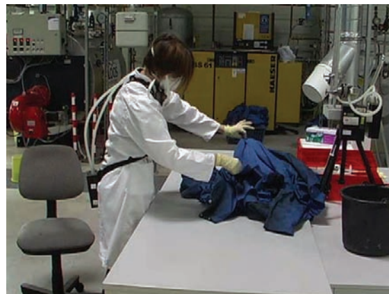
Messung der Chromatbelastung bei der Reinigung von Arbeitskleidung
