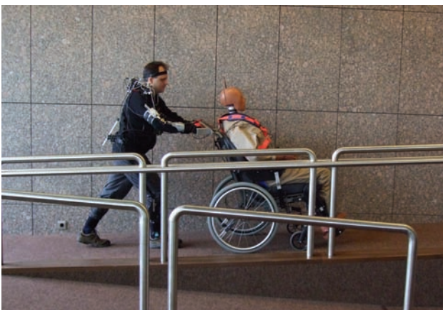
Belastungsmessung beim Ziehen und Schieben eines Rollstuhls
