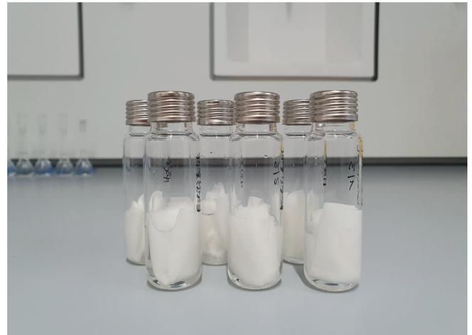
Bild 5 Extraktion der Zellstofftücher in Ethanol. Quelle: Autoren
