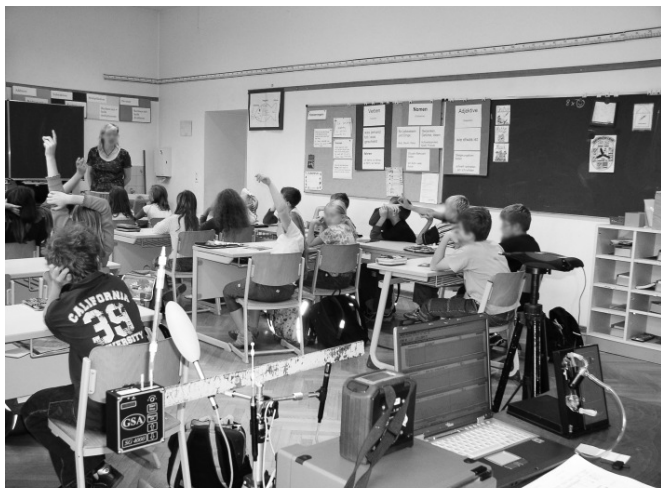
Messaufbau im Klassenraum für VOC, Aldehyde, MVOC, CO 2 , Raumklima und Lärm.
