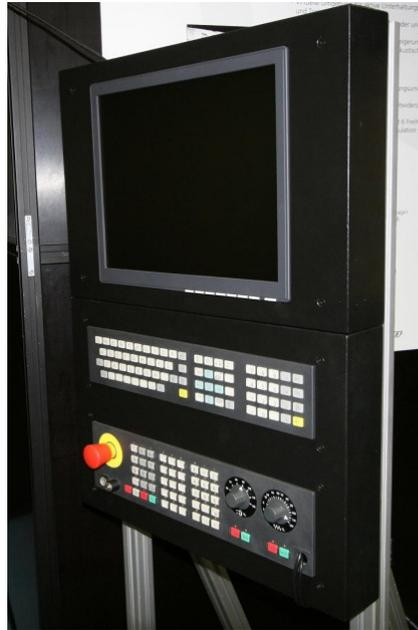
*Abbildung 4. Eine Maschinenbedientafel (Siemens SINUMERIK MCP 483), eine Industrietastatur und ein Computermonitor wurden derart in einen selbst hergestellten Rahmen eingebettet, dass sich ein realistischer Eindruck einer Drehmaschinensteuerung ergibt.*
