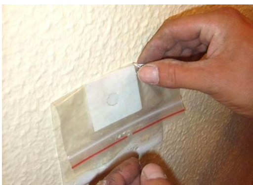
Abb. 9: Öffnung auf der Vorderseite der Schleuse durch Herunterklappen des oberen Teils der Folienschleuse verschließen.
