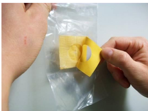
Abb. 3: Schutzfolie des doppelseitigen Klebebands auf der Rückseite der Schleuse entfernen.
