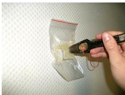
Abb. 6: Stanzeisen auf das doppelseitige Klebeband setzen.
