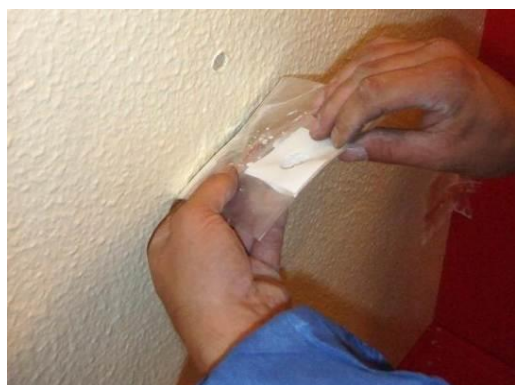
Abb. 10: Folienschleuse auf der Rückseite durch Umklappen des unteren Teils der Schleuse verschließen.
