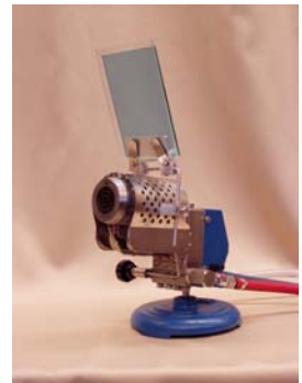
Bild 12: Brenner mit Schutzscheibe
