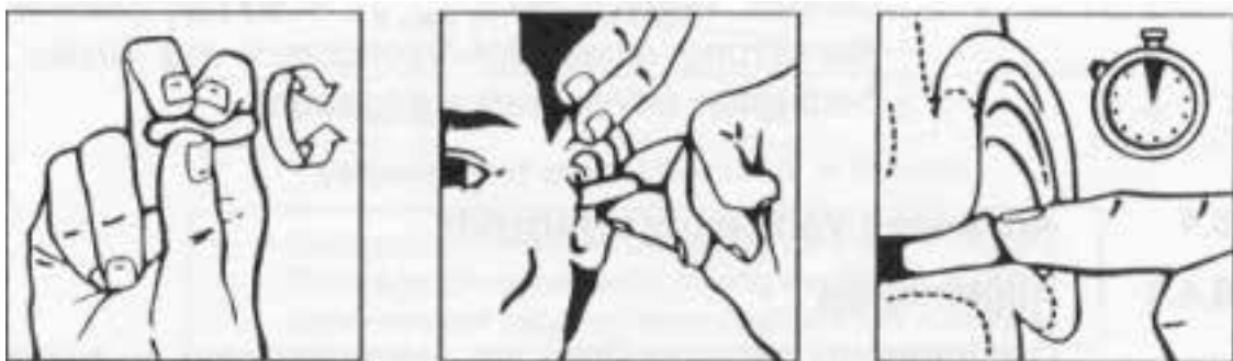
Bild 5: Einsetzen von Gehörschutzstöpseln (Quelle: Howard Leight)
