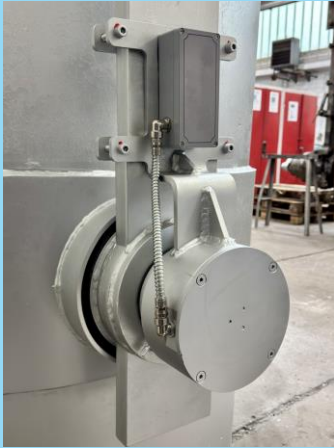
Abbildung 2 – Beispiel eines Datenerfassungsgerätes an einer Pfanne
