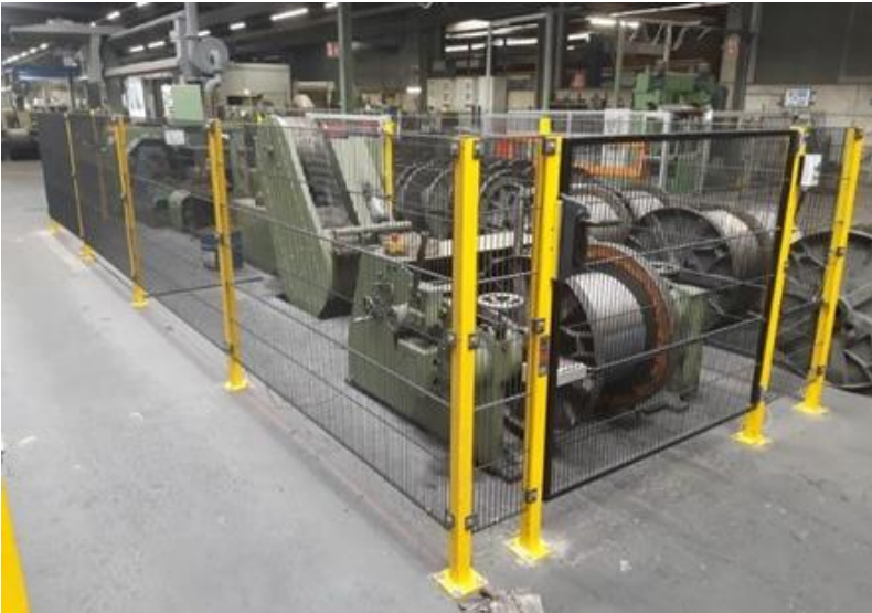
Abbildung 2 – Abzugseinrichtung und stehender Aufwickler einer Verseilmaschine. Zugang mittels Schutzzaun und zugehaltener Tür verhindert.
