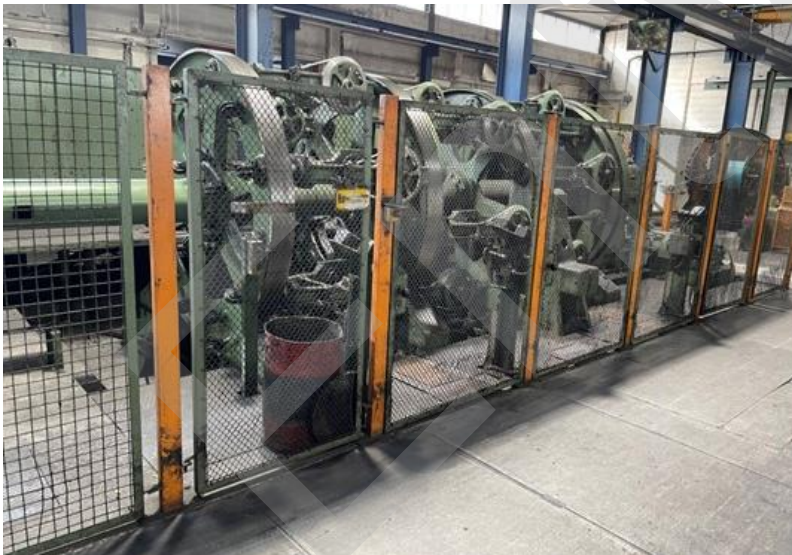
Abbildung 1 – Korbverseilmaschine: Die Wickelgutträger sind mit den einzelnen Verseilelementen in Spulenträgern konzentrisch um die Längsachse der Maschine gelagert. Zugang zum rotierenden Korb mittels feststehender trennender Schutteinrichtung verhindert.
