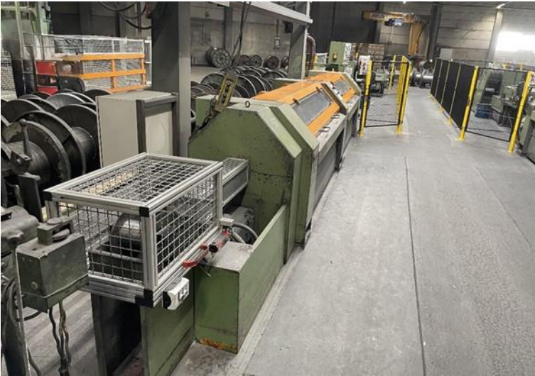
Abbildung 3 – Ablaufspule einer Rohrverseilmaschine, geschützt mittels zugehaltener Schutzhaube.
