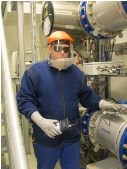
Bild 2: Durchführung einer Referenzmessung mit angelegter PSA
