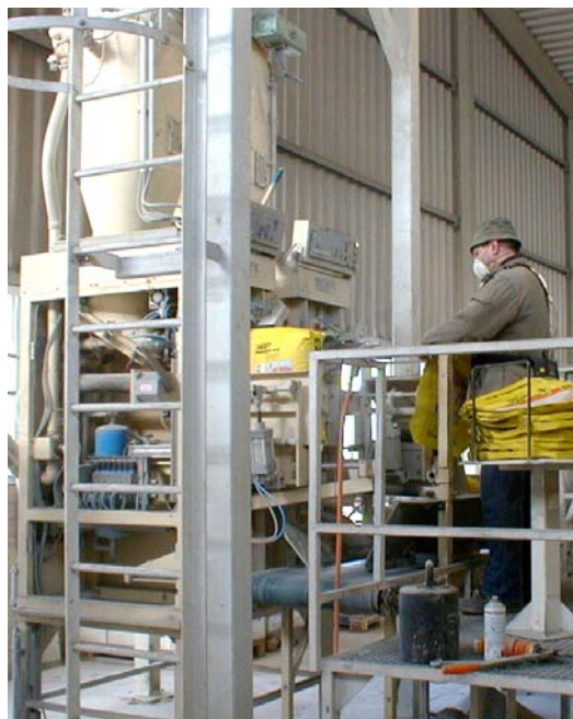
Abbildung 2-11: Messung der Quarzexposition bei der Absackung von Putz
