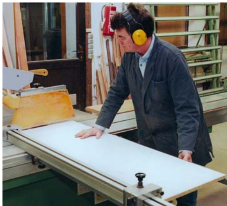
Abbildung 2-44: Holzbearbeitung mit Absaugung
