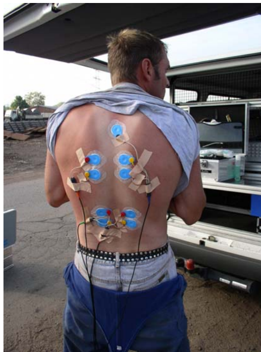
Abbildung 2-29: Elektroden zur Messung physiologischer Kenngrößen für die Einbindung in das CUELA-System
