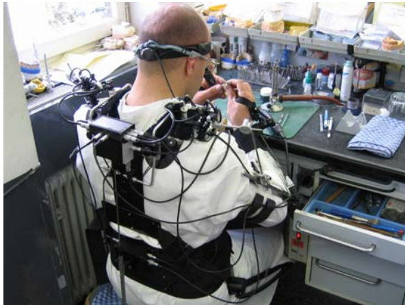
Abbildung 2-30: Erfassung der Schulter-Arm-Belastung an einem Zahntechnikerarbeitsplatz
