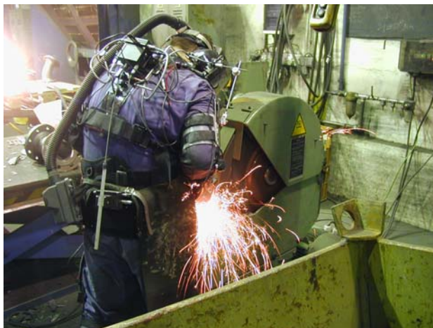
Abbildung 2-33: Belastungsmessung an einem Gussputzerarbeitsplatz
