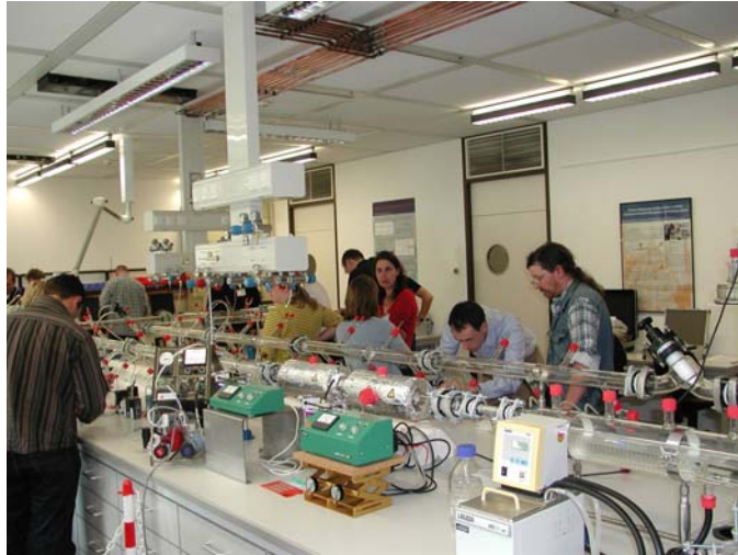
Abbildung 2-19: Die neu aufgebaute Prüfgasstrecke für Ringversuche
